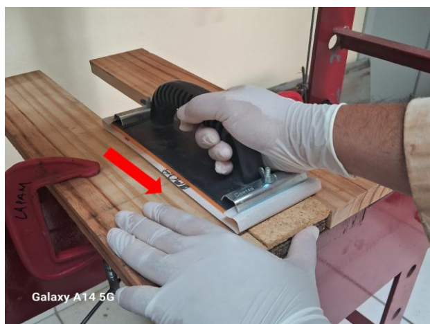
Figura 5 – Visualização do processo de lixamento com sentido de orientação descendente
