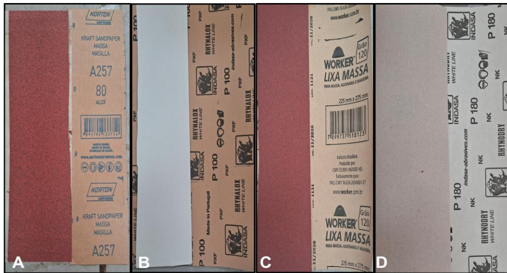
Figura 4 – Sequência de lixas utilizadas para o processo de usinagem e acabamento dos painéis: A) Lixa grana 80; B) Lixa grana 100; C) Lixa grana 120; D) Lixa grana 180
