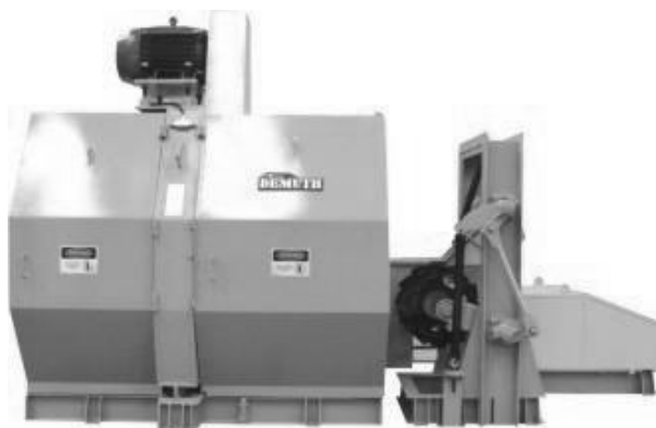
Figura 2 - Descascador em anel. Fonte: Catálogo Demuth, (2010).
