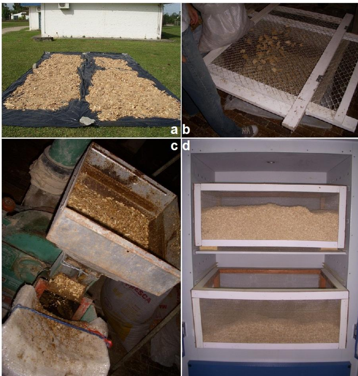
Figura 1 - (a) Secagem ao ar livre; (b) Divisão superdimensionados e subdimensionados; (c) Moinho de martelo; (d) Secagem em estufa de circulação forçada.
