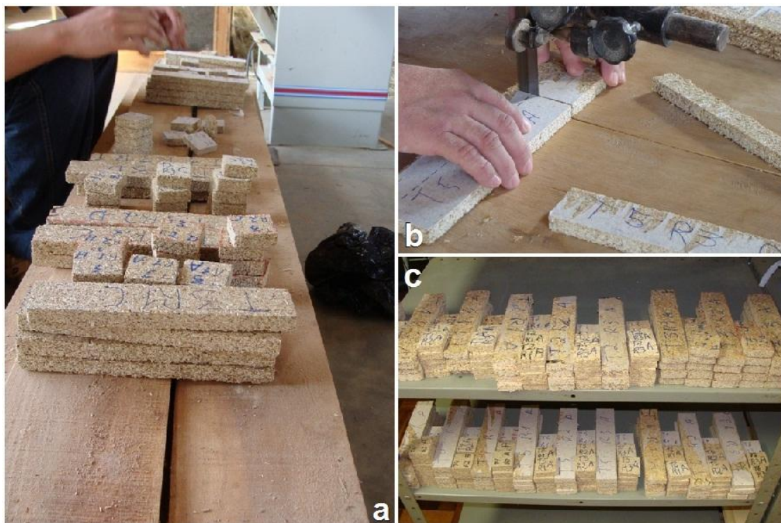
Figura 5 - (a) e (b) Confeção dos corpos de prova; (c) Corpos de prova na sala de climatização.
