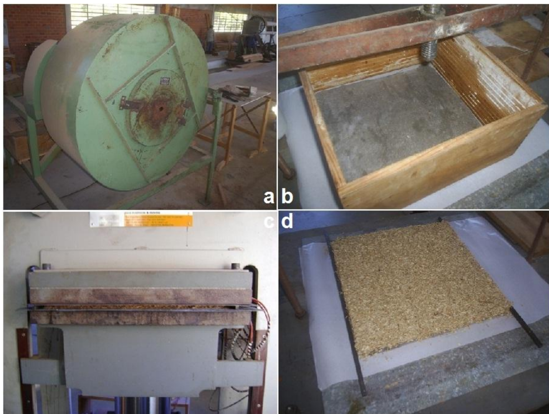
Figura 3 - (a) Encoladeira de partículas; (b) Caixa formadora para prensagem a frio; (c) Prensagem definitiva a quente; (d) Painel formado.
