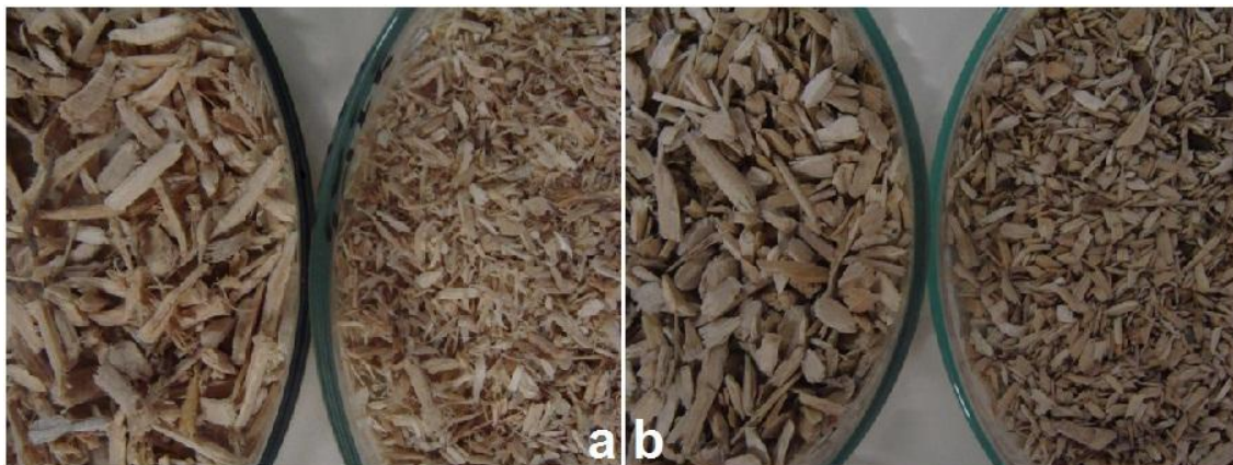
Figura 2 - (a) Cavacos superdimensionados: esquerda Classe1, direita Classe2; (b) Cavacos subdimensionados: esquerda Classe1, direita Classe2.
