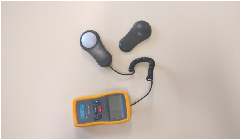
Figura 14 – Foto do luxímetro utilizado
