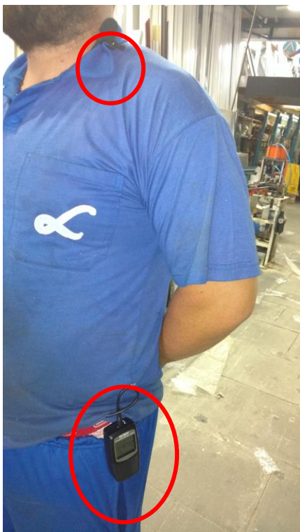
Figura 19 – Imagem do dosímetro instalado no funcionário
