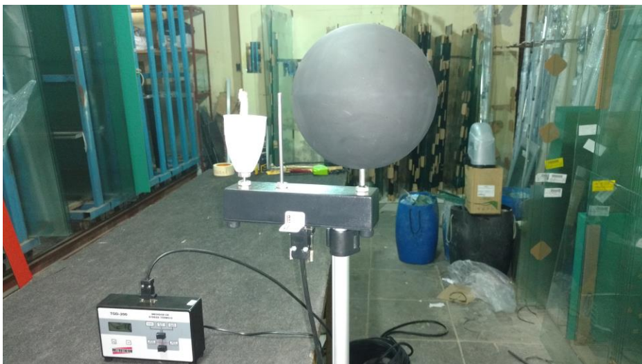
Figura 22 – Imagem do IBUTG utilizado
