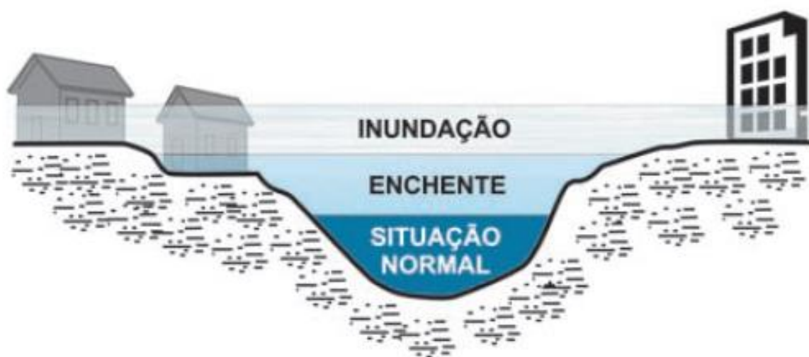
Figura 1. Perfil de uma situação de enchente e inundação. Fonte: Min. Cidades/IPT, 2007
