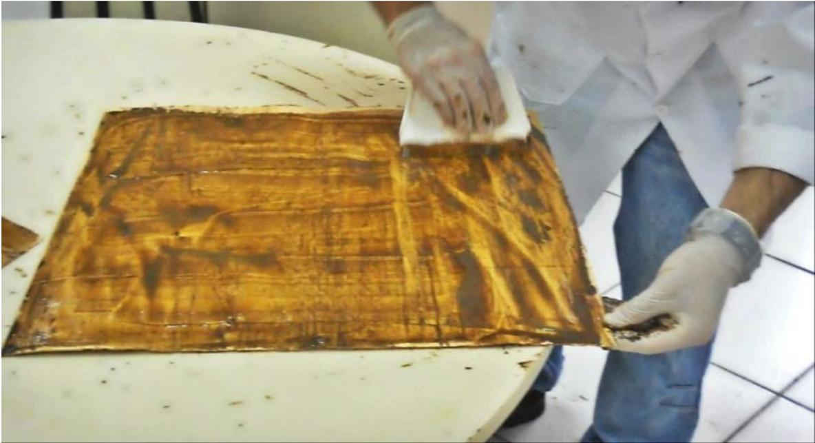
Figura 5 – Aplicação homogênea do adesivo fenólico com auxílio de uma espátula com ranhuras em uma das superfícies da lâmina de madeira.
