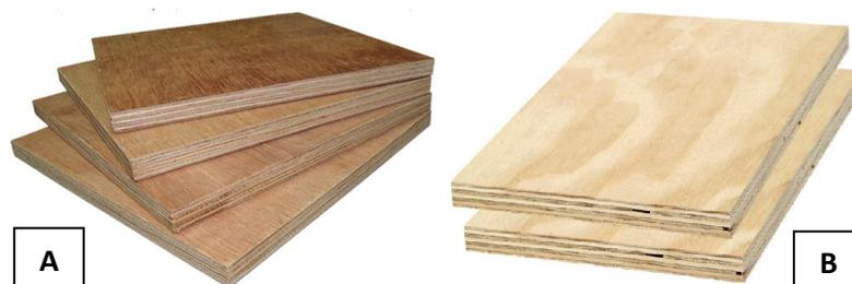
Figura 4 - Painéis compensados de Cajueiro (A) e pinus (B).
