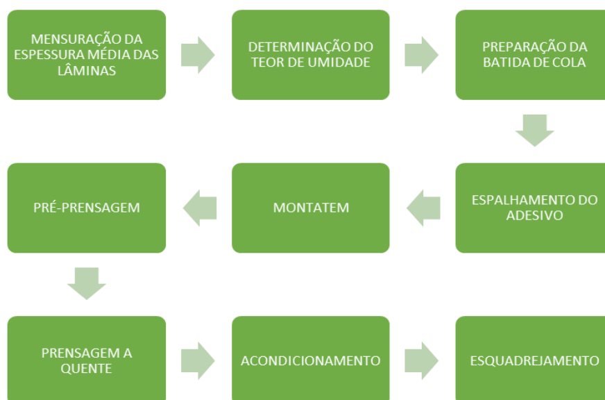
Figura 6 – Fluxograma do processo de produção do painel compensado.
