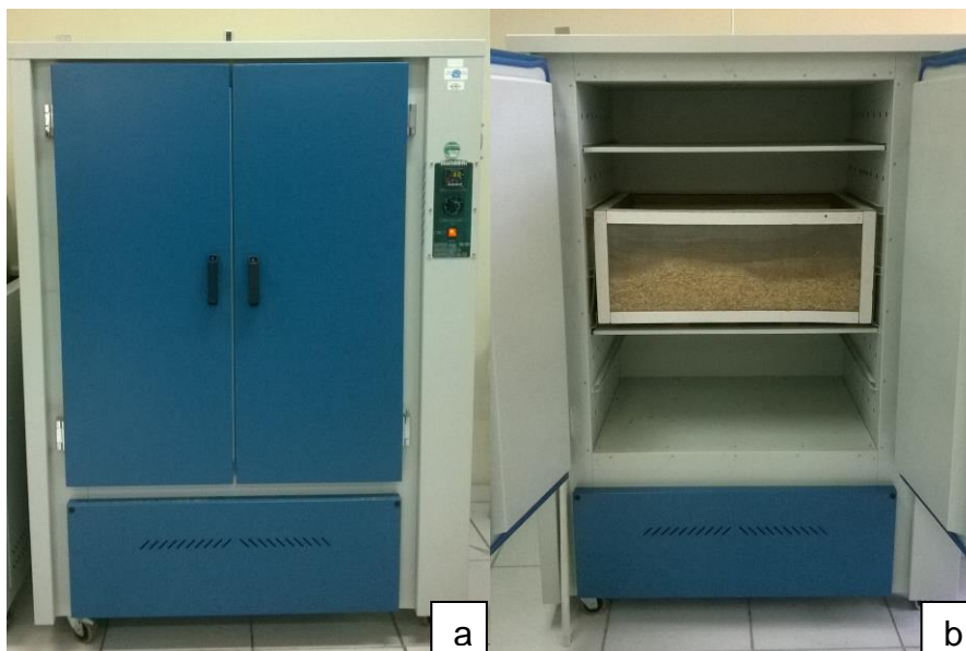
Figura 4 – a) Estufa com circulação de ar. b) Secagem das cascas de arroz em estrutura de madeira telada.
