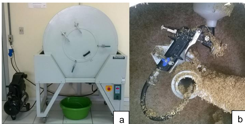
Figura 6 – a) Encoladeira. b) Pistola para aplicação do adesivo.
