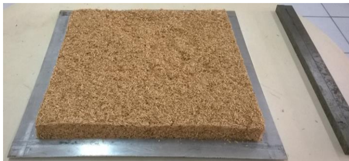
Figura 7 – Colchão formado e espaçadores de 25mm.
