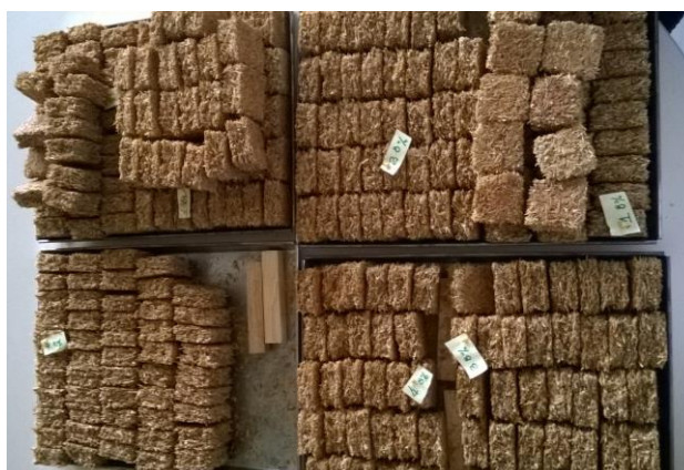
Figura 10 – Corpos de prova após a confecção em serra circular de bancada.
