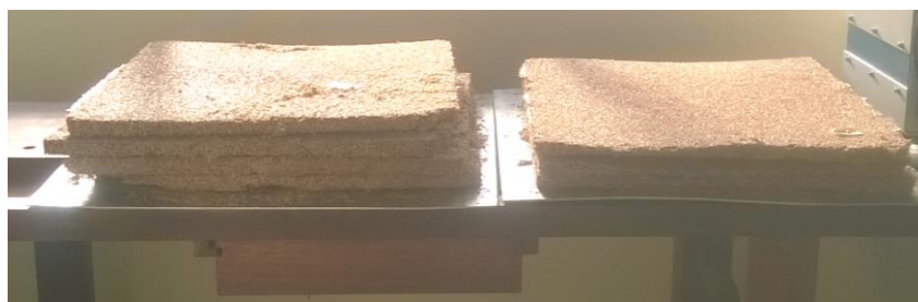
Figura 9 – Painéis com 8 e 10% de resina após prensagem.
