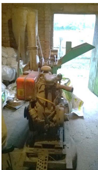
Figura 3 – Desintegrador DPM Nogueira utilizado no processamento das cascas de arroz.
