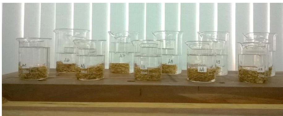
Figura 11 – Imersão dos corpos de prova em água destilada.
