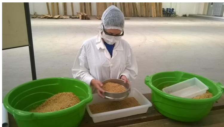
Figura 2 – Limpeza das cascas de arroz por meio de peneira de análise granulométrica.
