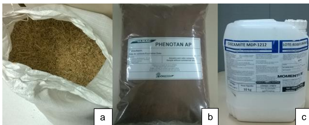
Figura 1 – a) Casca de arroz ( Oriza sativa L. ). b) Adesivo natural à base de tanino da casca de acácia negra. c) Resina sintética ureia-formaldeído.
