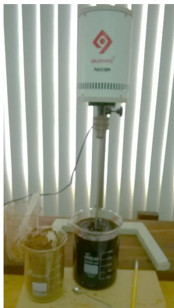
Figura 5 – Mistura de tanino em pó e água com auxílio do agitador mecânico.
