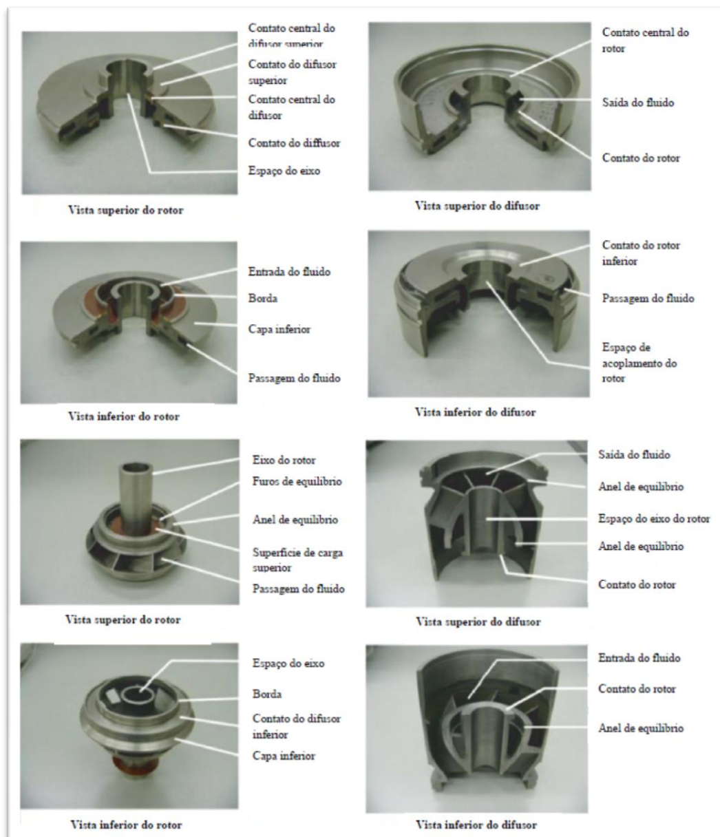
Figura 4-3. Rotor e difusor de tipo de fluxo radial e misto respectivamente.
