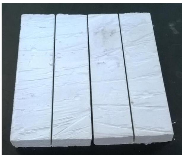
Figura 27 - Placa cimentícia cortada para ensaio de flexão a 3 pontos;
