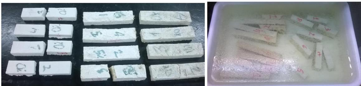
Figura 29 - Ensaio de absorção de água: corpos de prova secos (a) e imersos em água (b).
