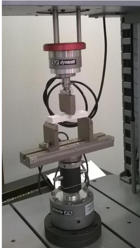
Figura 28 - Ensaio de flexão de 3 pontos.
