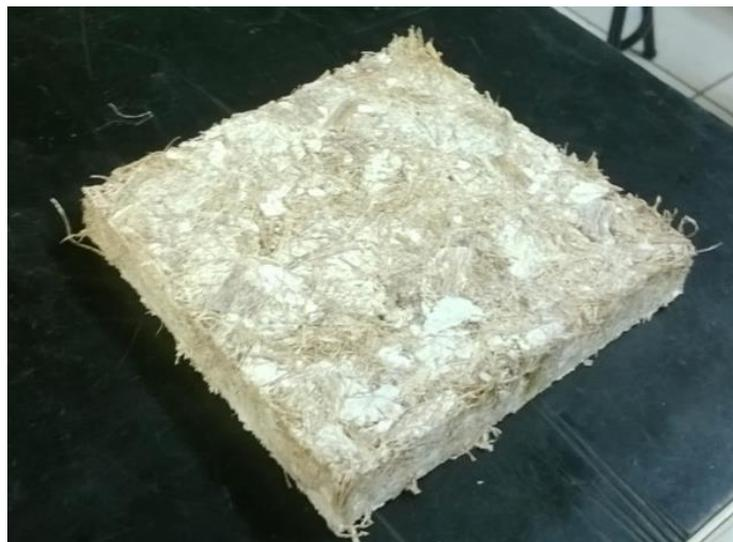
Figura 18 - Placa termo Isolante de Cimento Branco não estrutural.
