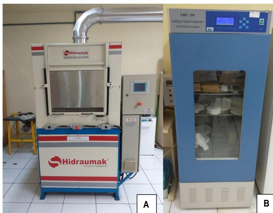
Figura 7 - Prensagem e acondicionamento dos painéis.
