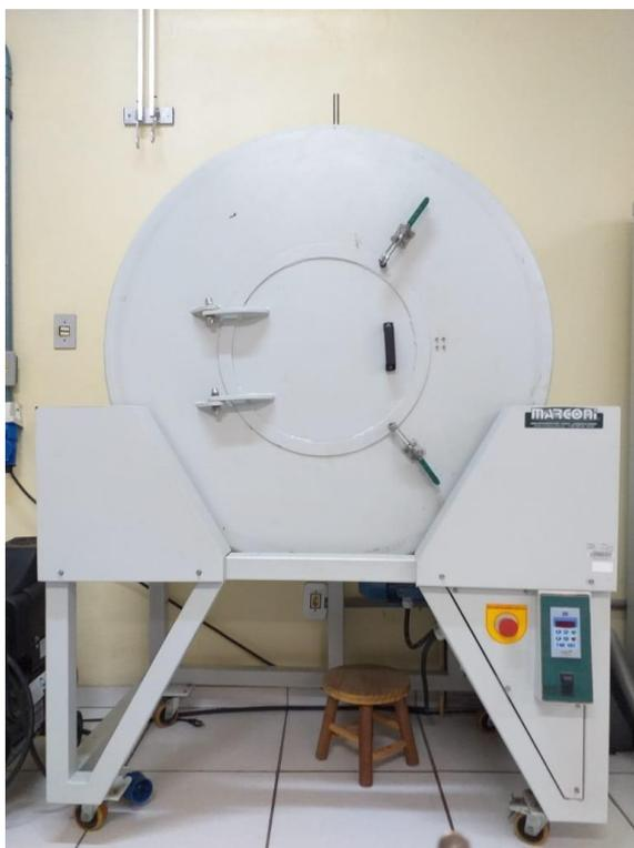
Figura 5 - Encoladeira de Partículas utilizada para aplicação do adesivo.
