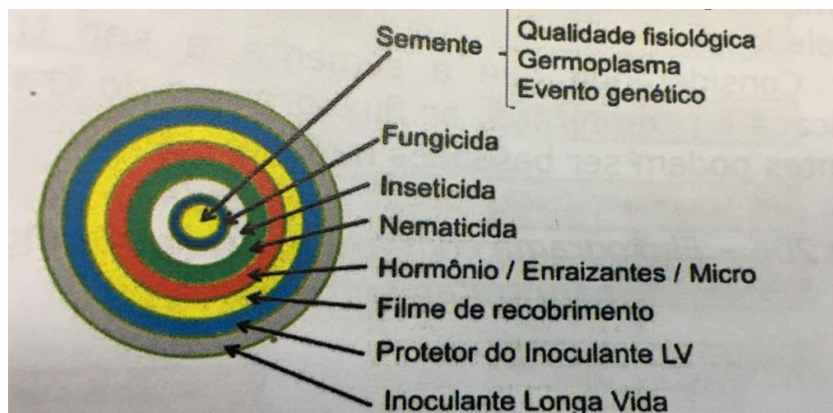
Figura 3. Sequência de produtos no tratamento de sementes industrial.
