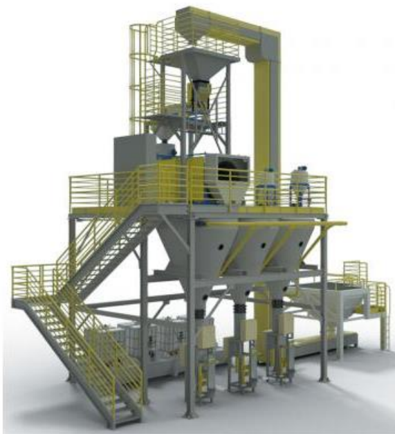
Figura 2. Unidade de tratamento de sementes na indústria.
