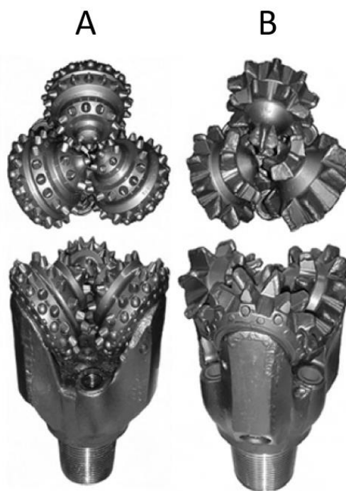
Figura 19. Brocas Tricônicas com Insertos de Tungstênio (esquerda) e Dentes de Aço (direita) Fonte: Adaptado de WAMSLEY JR e FORD, 2007.
