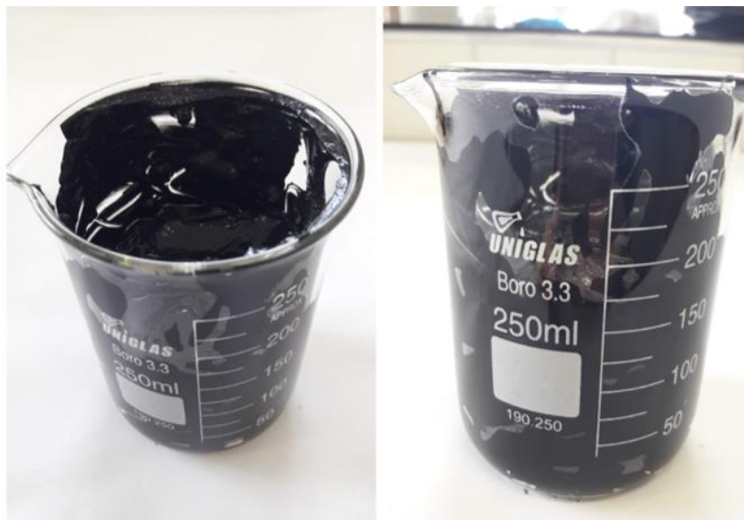
Figura 4- Borra oleosa em seu estado original. Borra B (de menor massa específica)
