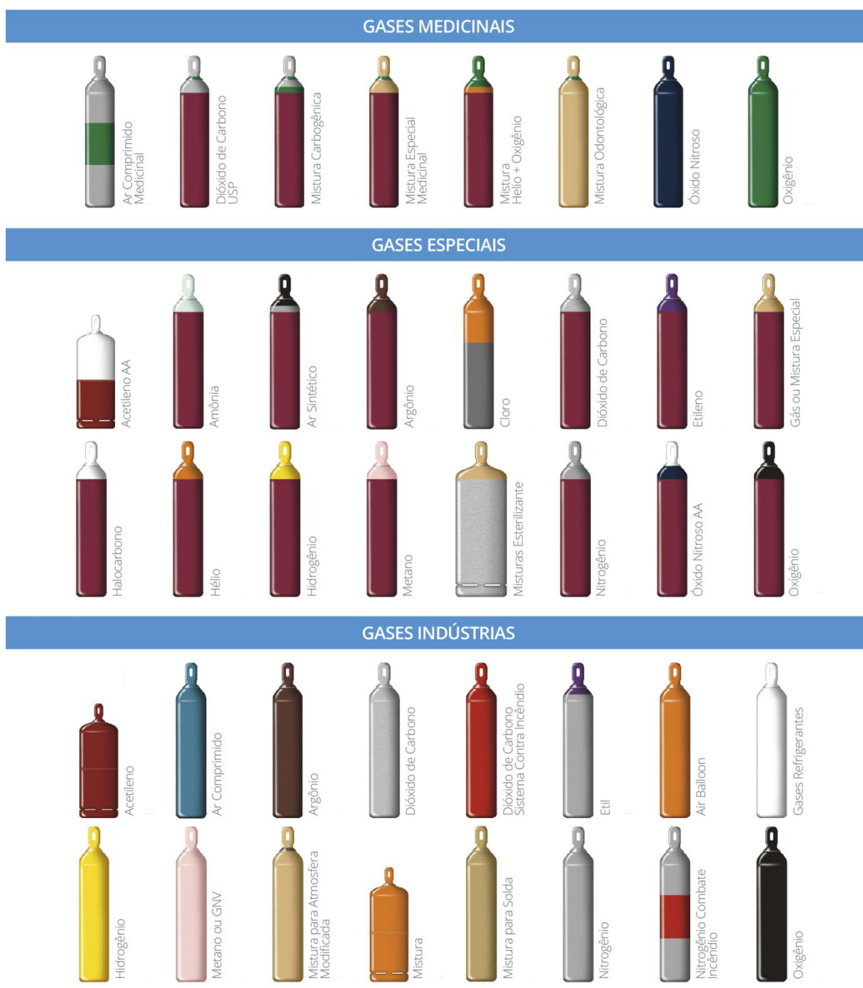
Figura 7. Cores dos cilindros Fonte: TRIGAS (2017).
