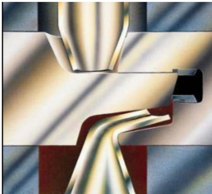
Figura 15 - Gaveta cega cortando a tubulação.
