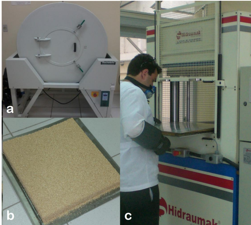
Figura 8 - Etapas do processo de prensagem: a) Encoladeira de partículas; b) Formação do colchão; c) Prensagem a quente.
