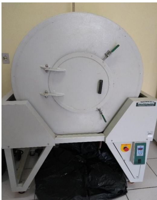
Figura 5 – Encoladeira de partículas, equipamento utilizado para aplicação da resina.
