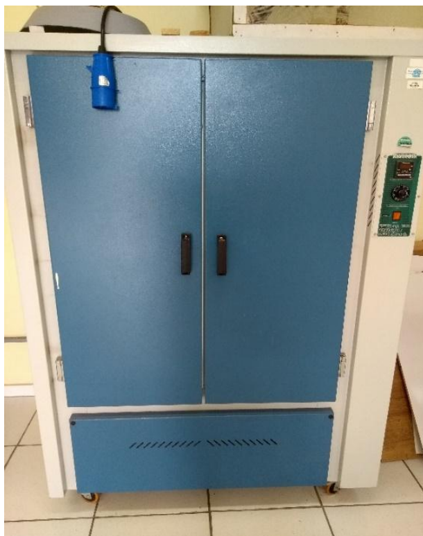
Figura 3 – Estufa com circulação forçada de ar utilizada para secagem dos materiais.
