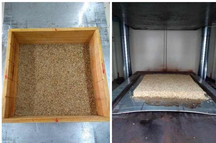
Figura 6 – Processo de formação do colchão de partículas e chapa pronta para a prensagem.
