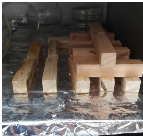
Figura 12 - Secagem em estufa das amostras para teor de umidade. Fonte: Autor, 2021.
