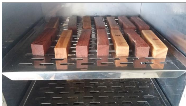
Figura 11 - Secagem em estufa das amostras impregnadas para retratibilidade. Fonte: Autor, 2021.
