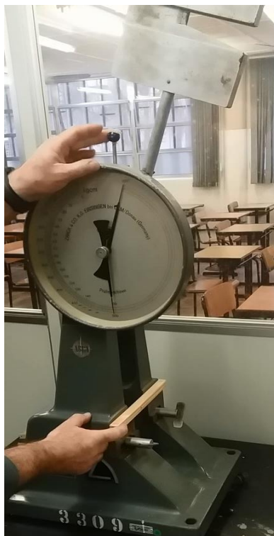
Figura 16 - Ensaio de flexão dinâmica. Fonte: Autor, 2021.
