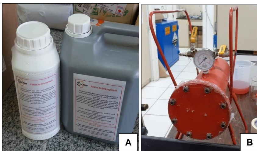
Figura 9 - Resina de impregnação Colméia Resinas (A) e Equipamento de tratamento autoclave (B). Fonte: Autor, 2021
