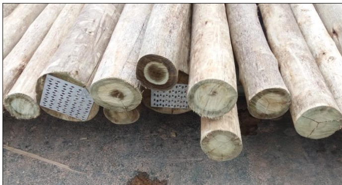
Figura 4 - Tratamento de postes por autoclave. Fonte: Autor, 2021.
