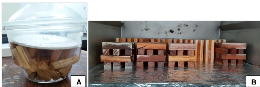
Figura 13 - Etapas de saturação (A) e secagem (B) das amostras impregnadas.
