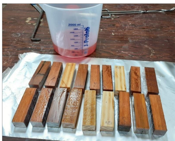
Figura 10 - Amostra após tratamento em autoclave. Fonte: Autor, 2021.
