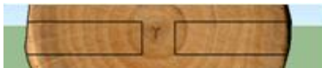
Figura 6 - Local onde foram retirados os corpos-de-prova. Fonte: Autor, 2021.
