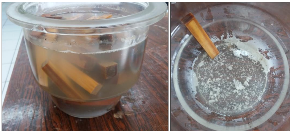
Figura 20 - Resina dissolvida após processo de saturação das amostras. Fonte: Autor, 2021.
