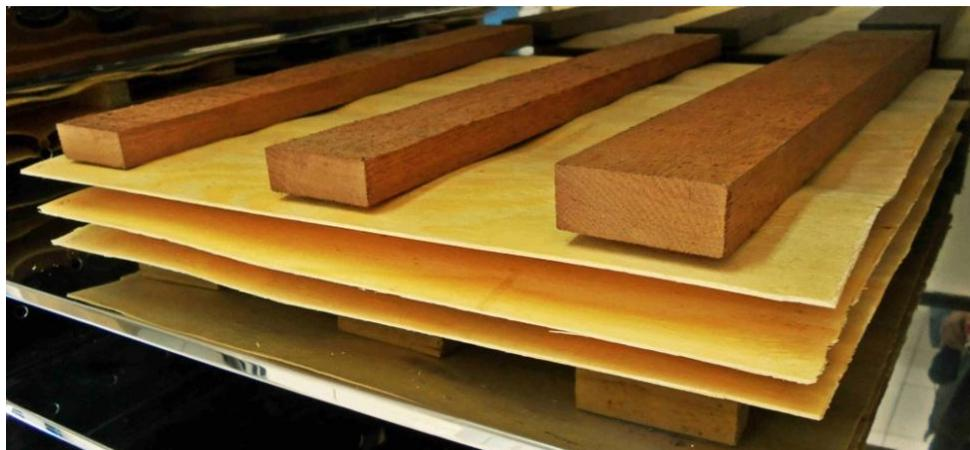
Figura 5 - Teste de secagem realizado nas lâminas de *Pinus taeda* em estufa convencional para a determinação do teor de umidade.
