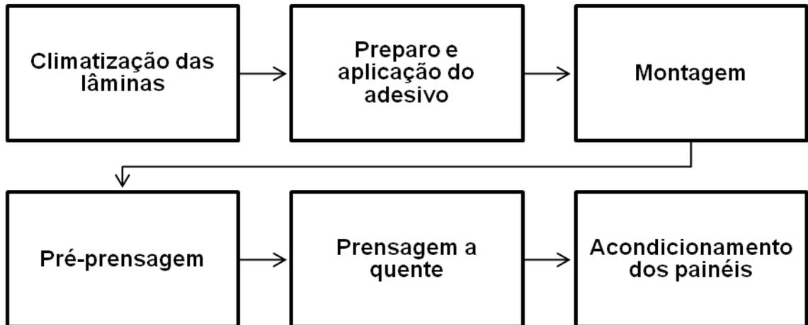
Figura 7 – Diagrama das etapas do processo produtivo dos painéis compensados e LVL.
