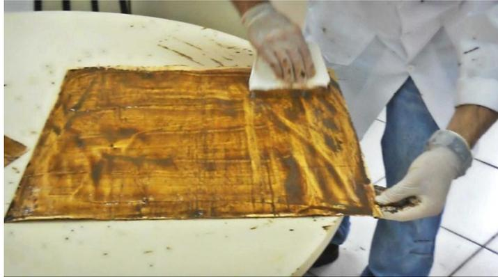
Figura 8 – Aplicação do adesivo sob as lâminas.
