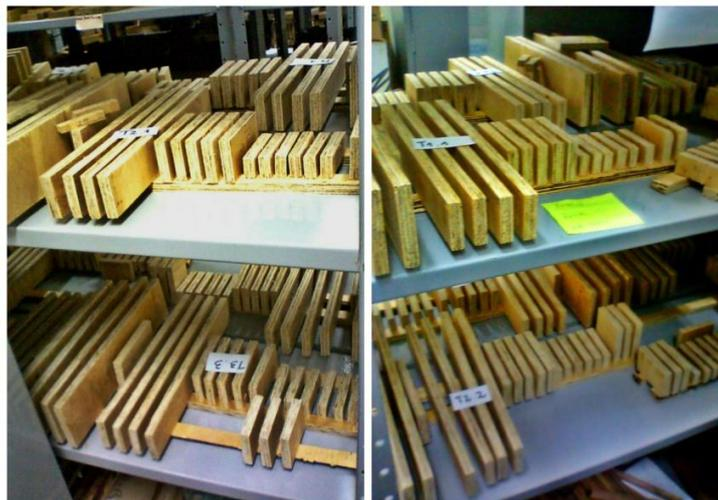
Figura 11 – Climatização dos corpos de prova dos painéis de madeira.
