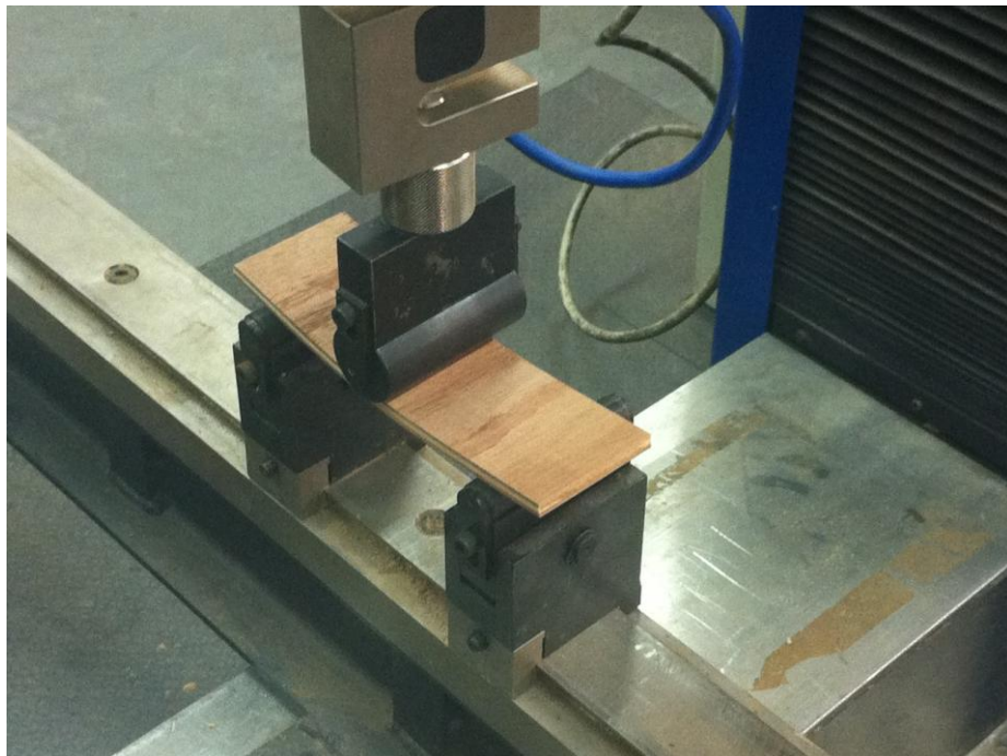
Figura 11 – Ensaio de resistência à flexão estática.
