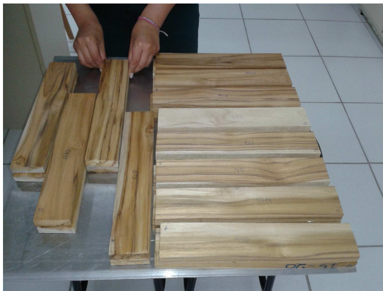
Figura 18 – Blocos com adesivo PVAc sendo preparados para o processo de prensagem.
