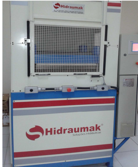
Figura 19: Prensa hidráulica empregada para colagem da madeira de teca. Fonte: A Autora, 2012.
