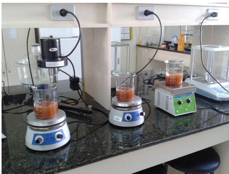
Figura 16 – Placas com agitação magnética para determinação da solubilidade em água fria.
