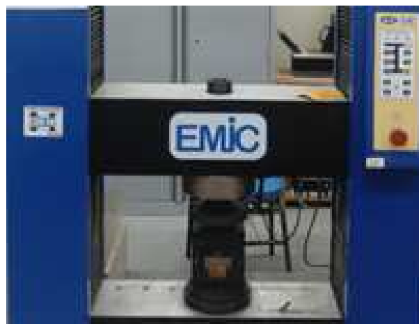
Figura 21 – Condução do ensaio resistência ao cisalhamento por compressão na linha de cola.
