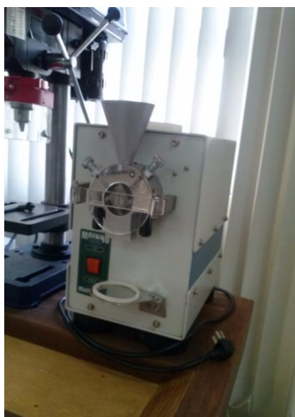
Figura 2 – Micro moinho de facas do tipo Willey .
