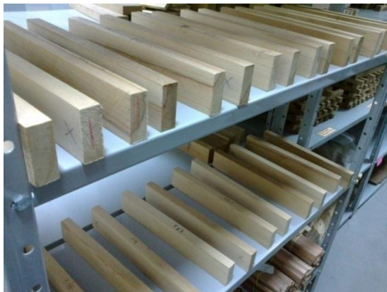
Figura 9 - Blocos dispostos em câmara climática.
