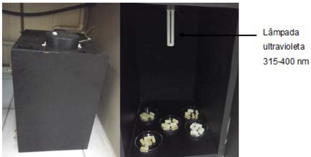
Figura 5: Caixa preta utilizada para o ensaio de envelhecimento acelerado com radiação ultravioleta.
