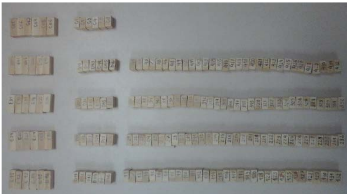
Figura 2: Foto dos corpos de prova da madeira de Pinus elliottii utilizados para ensaio de apodrecimento e envelhecimento acelerado.
