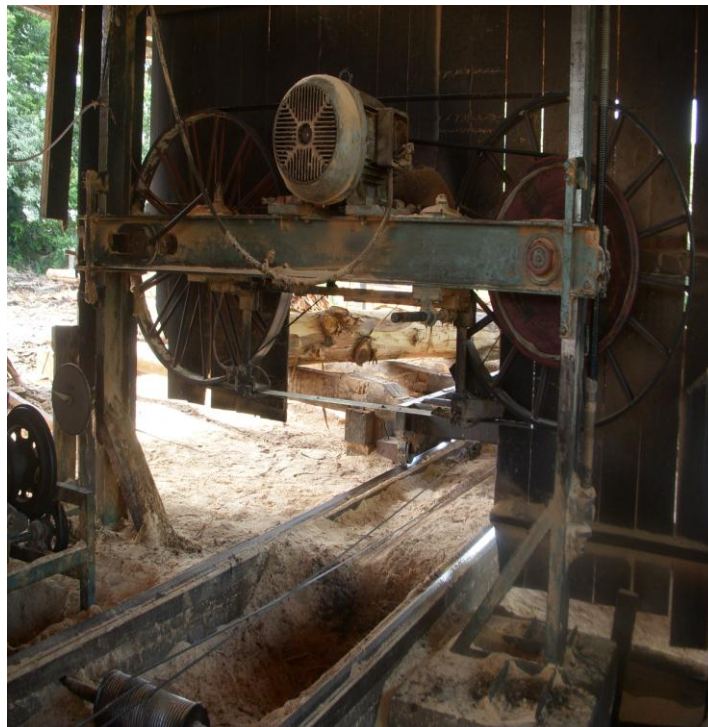
Figura 16 – Serra de fita horizontal utilizada para o desdobro principal.
