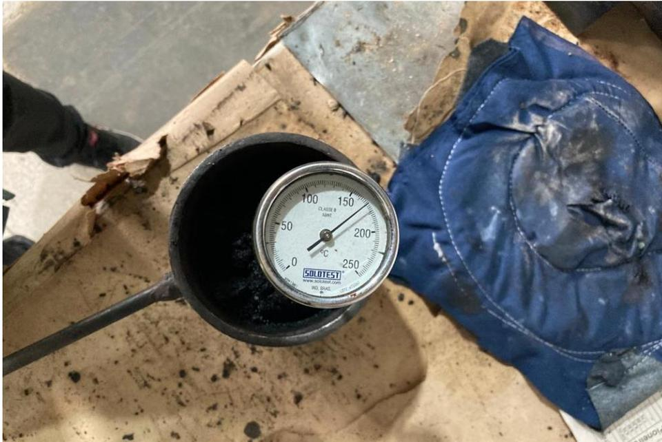
Figura 33 Aquecimento de CBUQ para moldagem do corpo de prova
