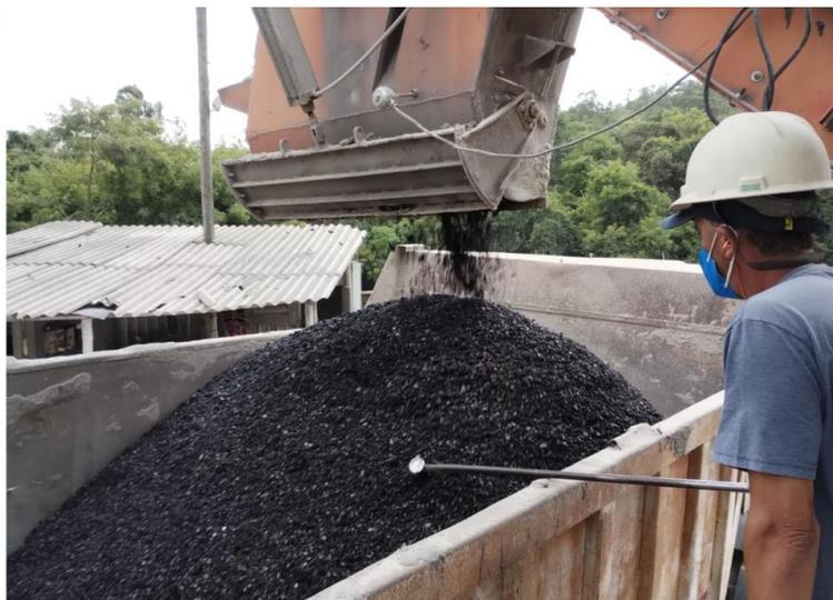
Figura 25 Retirada da amostra na usina
